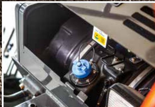
Door Adblue® in het uitlaatgas te injecteren neemt de uitstoot af.
