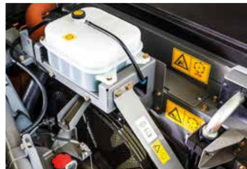
De expansietank voorkomt oververhitting van motoronderdelen.
